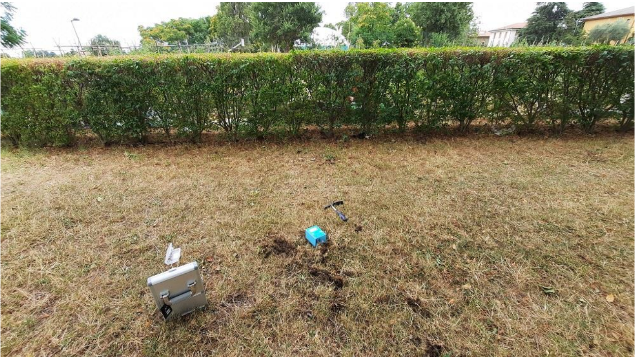
Foto 5: Indagine tromografica HVSR-2 in esecuzione
