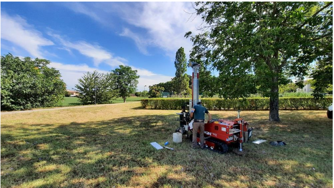
Foto 2: CPT-2 in esecuzione
