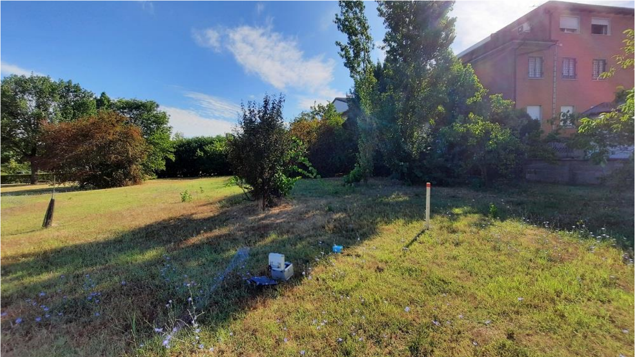
Foto 4: Indagine tromografica HVSR-1 in esecuzione
