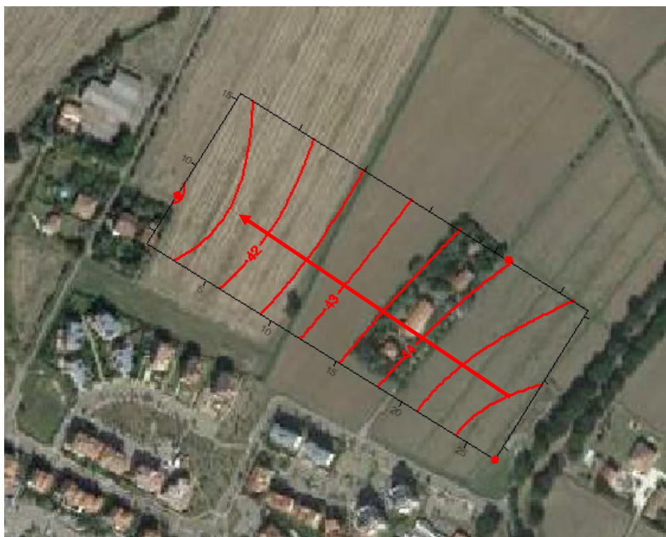
Fig. 6 – andamento delle isoipieze (m slm). La freccia indica la direzione del deflusso delle acque sotterranee
