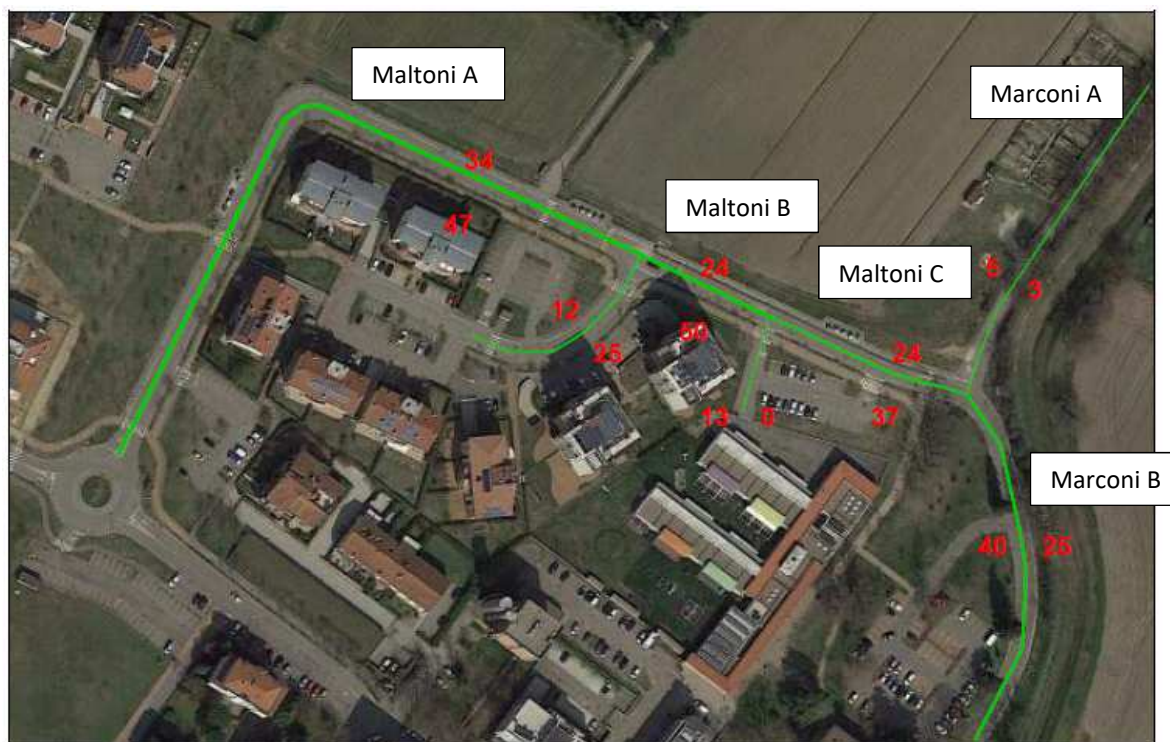
Flussi di traffico di scenario attuale per l'ora di punta del mattino
